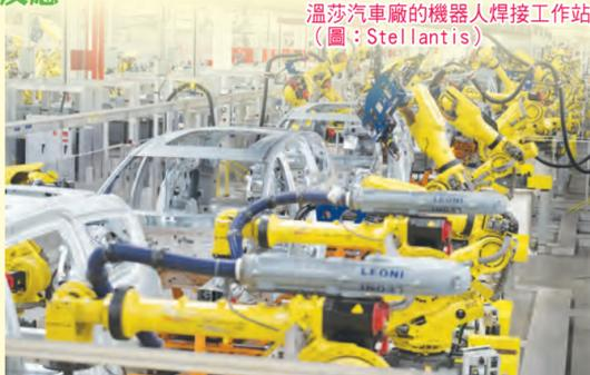
溫莎汽車廠的機器人焊接工作站 (圖: Stellantis)
